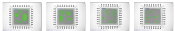
FIGURA 1. Reducción de vacíos en planos de tierra BTC como resultado de cambiar el diseño de apertura de I/O mientras se mantenía el mismo diseño de apertura de planos de tierra en el experimento original.
