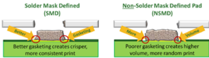
FIGURA 1. Efecto en la definición del pad en la impresión de soldadura en pasta.
