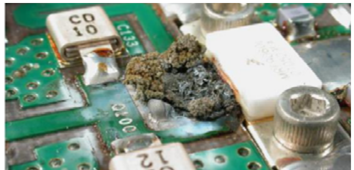
FIGURA 1. PCB con falla corrosiva.
