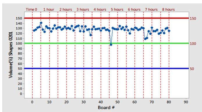
**FIGURA 4.** Valores SPI de los volúmenes de soldadura utilizando el limpiador bajo el estencil recomendado por AIM.
